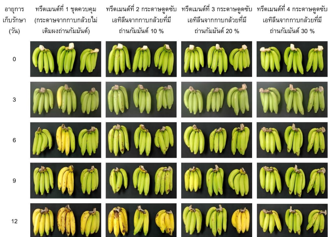
รูปที่ 3 ผลของกระดาดดูดซับเอทิลีนจากกล้วยที่มีถ่านกัมมันต์ในระดับความเข้มข้น 10, 20 และ 30 % เปรียบเทียบกับชุดควบคุม (กระดาดจากกล้วยที่ไม่เติมผงถ่านกัมมันต์) ต่อการเปลี่ยนแปลงลักษณะภายนอกของกล้วยหอมทองเมื่อเก็บรักษาที่อุณหภูมิ 25 \pm 2 องศาเซลเซียสเป็นระยะเวลา 12 วัน
