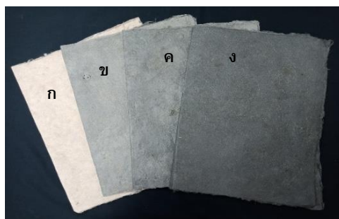
รูปที่ 1 ลักษณะและสีของกระดาษดูดซับเอทิลีนจากกากกล้วยที่ไม่เติมผงถ่านกัมมันต์ (ก) และที่เติมถ่านกัมมันต์ 10 % (ข) 20 % (ค) และ 30 % (ง) ตามลำดับ
