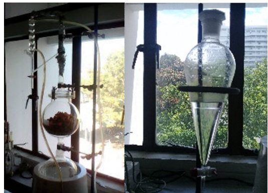
รูปที่ 2 อุปกรณ์สำหรับกลั่นน้ำมันหอมระเหย
