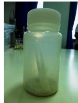
รูปที่ 3 อาหารเลี้ยงเชื้อชนิด LPB ก่อนใส่ตัวอย่างน้ำภายในมีหลอดดักแก๊ส
