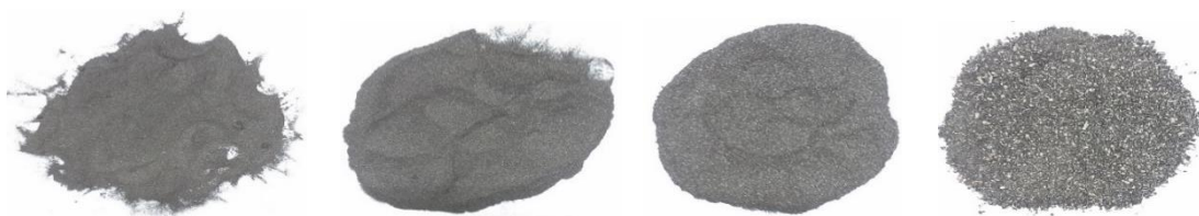
รูปที่ 1 ผงตะไบเหล็กขนาด <38, 38-45, 75-90 ไมครอน และคละขนาด ตามลำดับ
