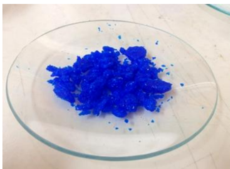
รูปที่ 5 ลักษณะของ \text{Cu}(\text{NO}_3)_2 (ก) ทางการค้า (QReC) และ (ข) ที่เตรียมได้
