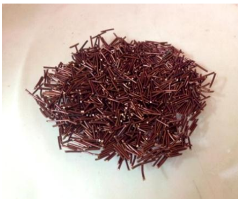
รูปที่ 1 ลวดทองแดงในอะไหล่การถยนต์ถูกตัดให้มีขนาด 0.5 cm
