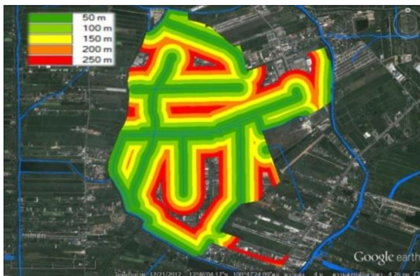
รูปที่ 5 แนวกันชนแบบหลายชั้น (multiring buffer) ของเส้นทางน้ำโดยการทำให้ระยะห่างจากเส้นทางน้ำทั้งสองฝั่งออกไปเป็นระยะ 50, 100, 150, 200 และ 250 เมตร
