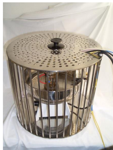
รูปที่ 6 ชุดประกอบอุปกรณ์จับชิ้นงานและการป้องกันด้วยกรงฟาราเดย์
