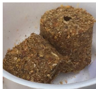
รูปที่ 1 ตัวอย่างแท่งเชื้อเพลิงชีวมวลจากเปลือกสับปะรด
