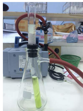
รูปที่ 1 การไล่สารคาร์เบนดาซิมออกจากตัวดูดซับ diatomaceous earth
