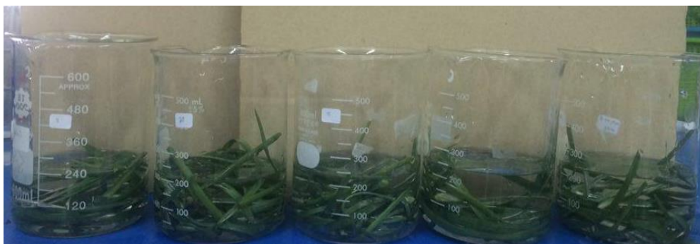
รูปที่ 1 การทดสอบการดูดกลืนสารคาร์เบนดาซิมของใบกุยช่าย
