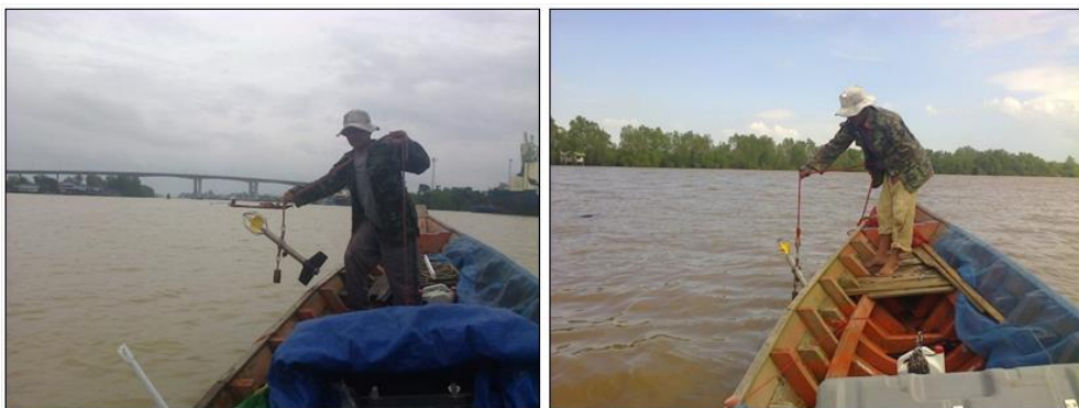
รูปที่ 5 การตรวจวัดกระแสน้ำ
