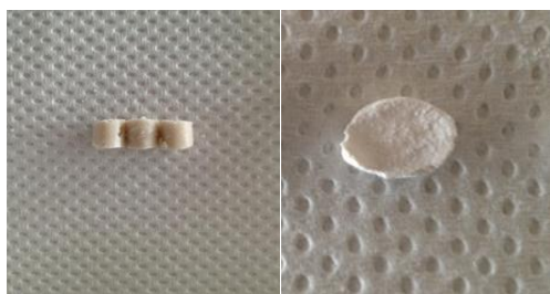
รูปที่ 1 ลักษณะตัวเร่งปฏิกิริยาแคลเซียมออกไซด์แบบเม็ด
