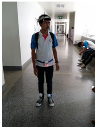
รูปที่ 10 การทดสอบการทำงานของเครื่องแจ้งเตือนสิ่งกีดขวางสำหรับผู้พิการทางสายตา
