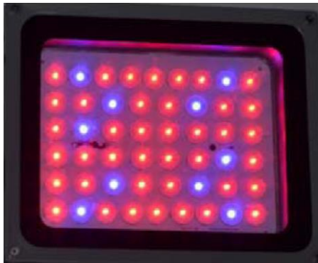
รูปที่ 7 แหล่งกำเนิดแสงสำหรับพืชที่ใช้ไดโอดเปล่งแสงสีแดง สีนํ้าเงิน และสีขาว (RBW) และแสงจากหลอดฟลูออเรสเซนต์ (FL) และแสงจากไดโอดเปล่งแสงสีแดงและสีนํ้าเงิน (RB) แสดงในรูปที่ 8
