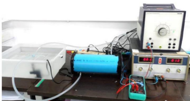
รูปที่ 4 ขดลวดโซลินอยด์และการต่อวงจรสำหรับสนามแม่เหล็ก
