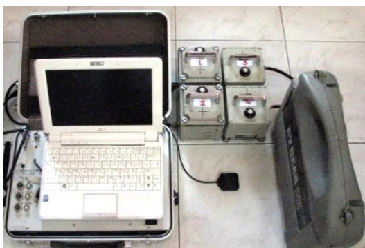
รูปที่ 2 ชุดอุปกรณ์สำหรับการตรวจวัดความเร็วของการสั่นสะเทือน
