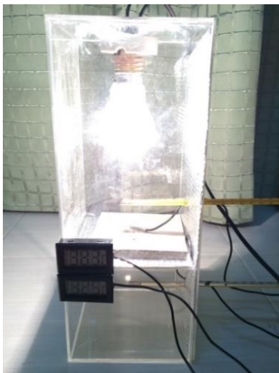
รูปที่ 2 ห้องจำลอง (ตู้ทดสอบ) สำหรับทดสอบการกันความร้อน
