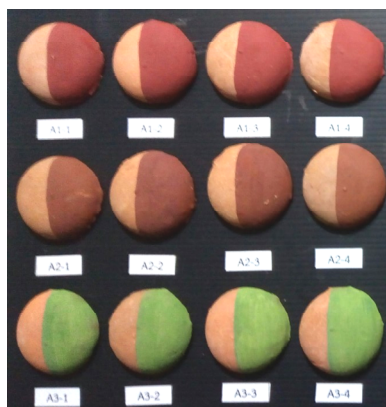
ภาพที่ 5 แผ่นทดลองแสดงผลการหาอัตราส่วนผสมสีฝุ่นผสมซีเมนต์ ATM ชุด A
