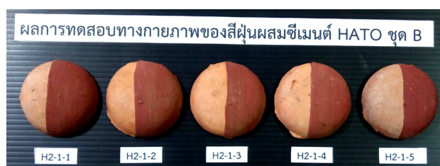
ภาพที่ 10 แผ่นทดลองแสดงผลการหาอัตราส่วนผสมสีฝุ่นผสมซีเมนต์ HATO ชุด B
