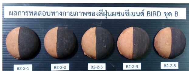
ภาพที่ 12 แผ่นทดลองแสดงผลการหาอัตราส่วนผสมสีฝุ่นผสมซีเมนต์ BIRD ชุด B
