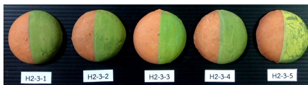
ภาพที่ 11 แผ่นทดลองแสดงผลการหาอัตราส่วนผสมสีฝุ่นผสมซีเมนต์ HATO สีเขียว ชุด B
