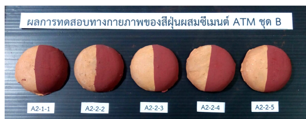
ภาพที่ 8 แผ่นทดลองแสดงผลการหาอัตราส่วนผสมสีฝุ่นผสมซีเมนต์ ATM สีแดง ชุด B
