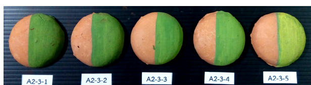
ภาพที่ 9 แผ่นทดลองแสดงผลการหาอัตราส่วนผสมสีฝุ่นผสมซีเมนต์ ATM สีเขียว ชุด B
