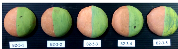
ภาพที่ 13 แผ่นทดลองแสดงผลการหาอัตราส่วนผสมสีฝุ่นผสมซีเมนต์ HATO สีเขียว ชุด B
