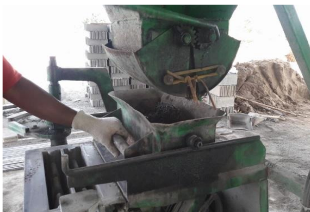
ภาพที่ 3 ขั้นตอนการอัดคอนกรีตบล็อกด้วยเครื่องจักร
