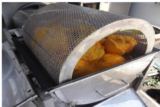
ภาพที่ 6 การเตรียมถังปั่นในการแยกเนื้อผลตาลโตนด
