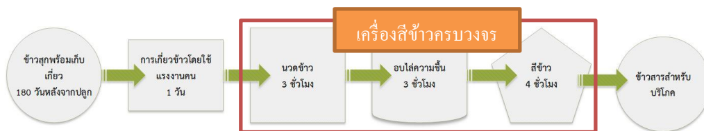
ภาพที่ 12 แผนภาพการทำงานของเครื่องสีข้าวครบวงจรสำหรับสีข้าวไม่ดรีน
