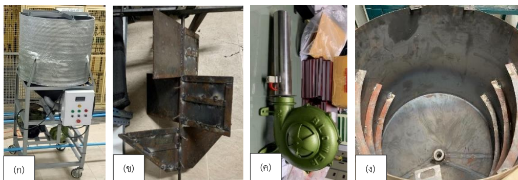
ภาพที่ 4 อุปกรณ์ประกอบเครื่องอบแห้งข้าวเปลือก (ก) เครื่องอบแห้งข้าวเปลือก (ข) ใบกวนข้าวภายในถัง (ค) ชุดเป่าลมร้อน (ง) ถังด้านในติดครีบบงเดียน
