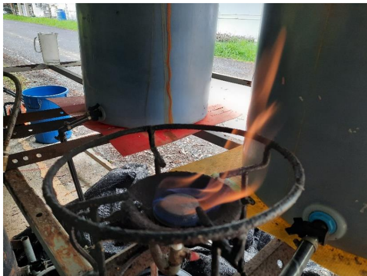
ภาพที่ 4 การทดสอบการจุดติดไฟของก๊าซชีวภาพจากน้ำเสียจากกระบวนการผลิตขนมลา
