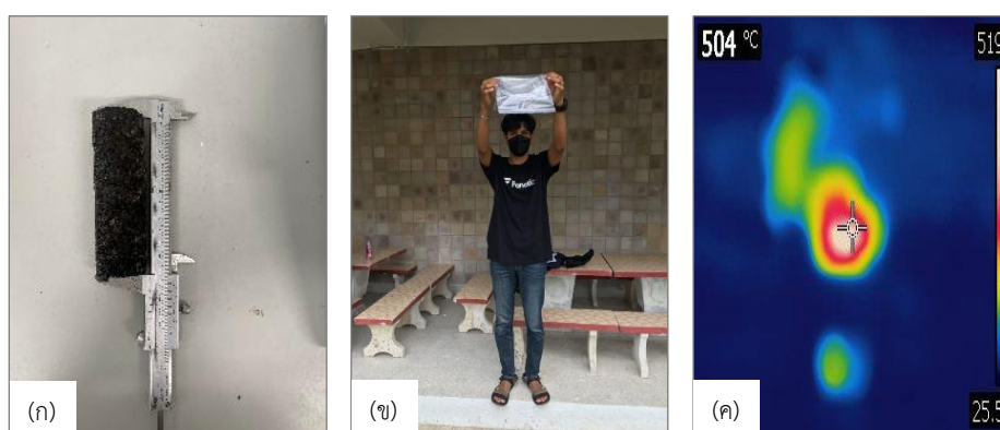
ภาพที่ 4 การทดสอบสมบัติเชิงกลของถ่านชีวมวลอัดแท่ง โดยหาปริมาณเพื่อวิเคราะห์หาความหนาแน่น (ก) วิธีการทดสอบการตกจากที่สูง (ข) และภาพจากกล้องถ่ายภาพความร้อนการเผาไหม้เชื้อเพลิง (ค)
