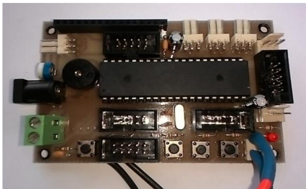
ภาพที่ 4 วงจรไมโครคอนโทรลเลอร์
