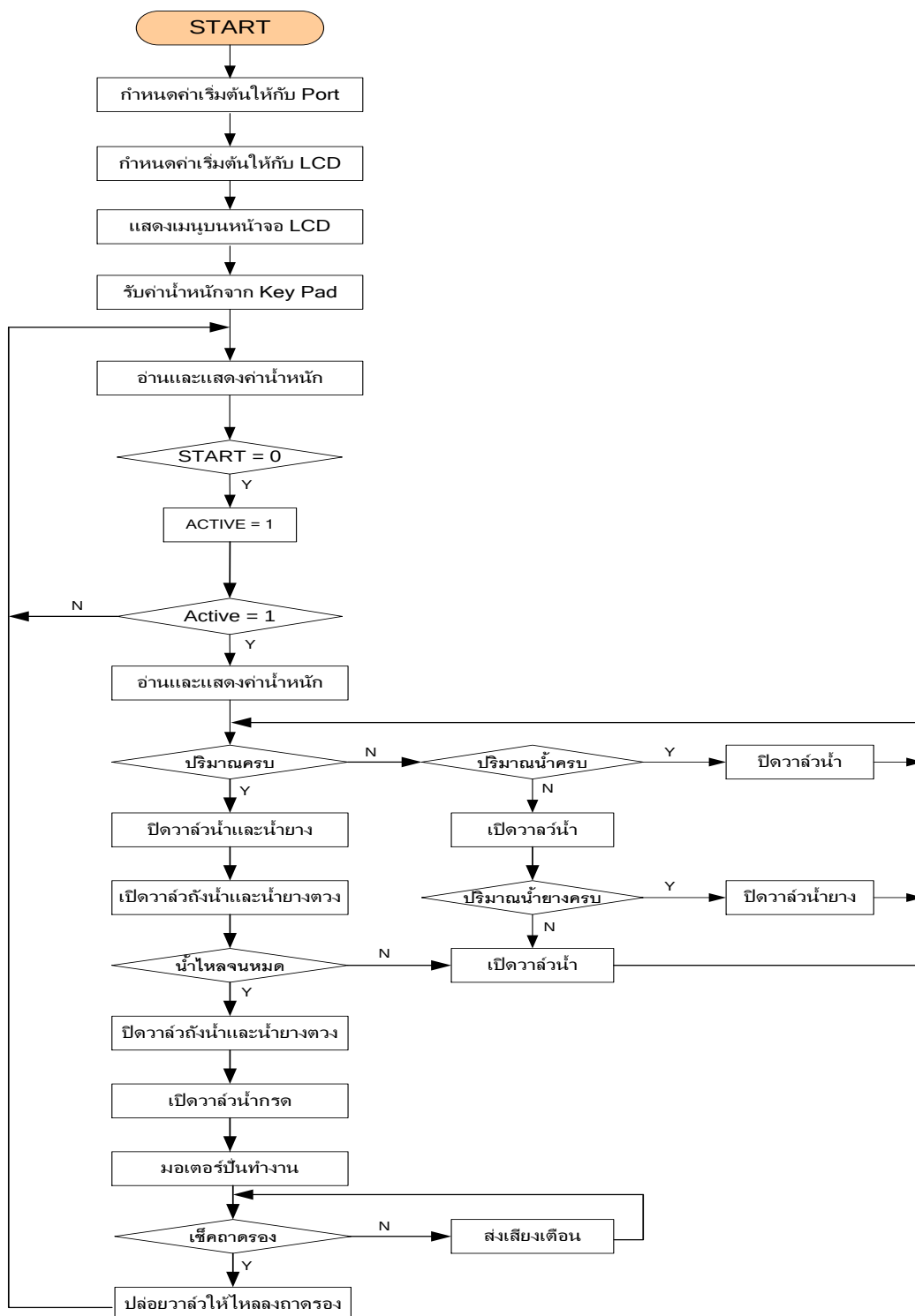
ภาพที่ 7 ขั้นตอนการควบคุมการทำงานของเครื่องผสมน้ำยางพารากิ่งอัตโนมัติ
