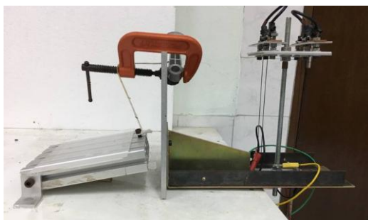
ภาพที่ 1 การทดสอบสัมประสิทธิ์แรงเสียดทานด้วยวิธีหามุมเอียง
