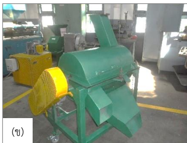
ภาพที่ 1 การเตรียมเส้นใยเปลือกมะพร้าว โดยมีเปลือกมะพร้าว (ก) เครื่องแยกเส้นใยและขุยจากเปลือกมะพร้าว (ข) และเส้นใยเปลือกมะพร้าว (ค)
