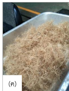
ภาพที่ 1 การเตรียมเส้นใยเปลือกมะพร้าว โดยมีเปลือกมะพร้าว (ก) เครื่องแยกเส้นใยและขุยจากเปลือกมะพร้าว (ข) และเส้นใยเปลือกมะพร้าว (ค)
