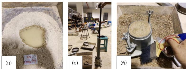
ภาพที่ 5 การทดสอบความหนาแน่นของดิน โดยผสมน้ำกับดินเพื่อช่วยการบดอัด (ก) อุปกรณ์การบดอัดดินในโมลต์ (ข) และตัวอย่างดินที่ผ่านการบดอัด (ค)
