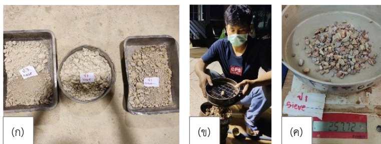
ภาพที่ 4 การเตรียมตัวอย่างดินที่ 1 2 และ 3 (ก) การวิเคราะห์การกระจายขนาดมวลดิน (ข) และการหาสัดส่วนของขนาดมวลดิน (ค)
