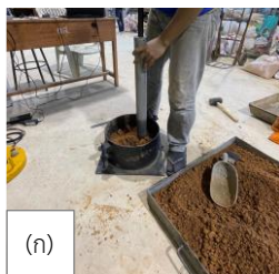
ภาพที่ 7 การทดสอบเพลาแบบพลศาสตร์ โดยการเตรียมตัวอย่างดิน (ก) การแต่งตัวอย่างดิน (ข) การทดสอบให้น้ำหนักกระทำต่อตัวอย่างดิน (ค) และการอ่านและบันทึกค่าผลการทดสอบเพื่อการวิเคราะห์เพิ่มเติม (ง)
