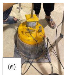
ภาพที่ 7 การทดสอบเพลาแบบพลศาสตร์ โดยการเตรียมตัวอย่างดิน (ก) การแต่งตัวอย่างดิน (ข) การทดสอบให้น้ำหนักกระทำต่อตัวอย่างดิน (ค) และการอ่านและบันทึกค่าผลการทดสอบเพื่อการวิเคราะห์เพิ่มเติม (ง)
