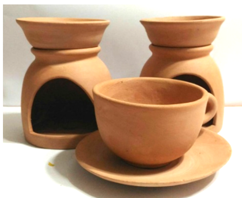
ภาพที่ 9 ผลิตภัณฑ์หล่อแม่พิมพ์ จากดินหล่อ ชุด B อัตราส่วนผสมลำดับที่ 11 หลังเผา
