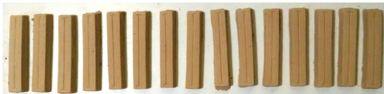
ภาพที่ 6 แท่งทดสอบน้ำดินหล่อแม่พิมพ์ ชุด B ก่อนเผา
