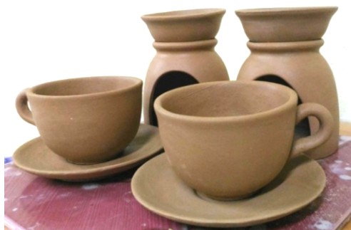
ภาพที่ 8 ผลิตภัณฑ์หล่อแม่พิมพ์ จากดินหล่อ ชุด B อัตราส่วนผสมลำดับที่ 11 ก่อนเผา
