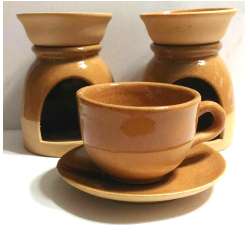
ภาพที่ 12 ผลิตภัณฑ์หล่อแม่พิมพ์ จากดินหล่อ ชุด B อัตราส่วนผสมลำดับที่ 11 หลังเผาเคลือบที่อุณหภูมิ 1,100 องศาเซลเซียส
