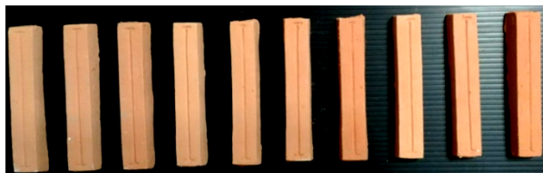
ภาพที่ 4 แท่งทดสอบน้ำดินหล่อแม่พิมพ์ ชุด A ก่อนเผา
