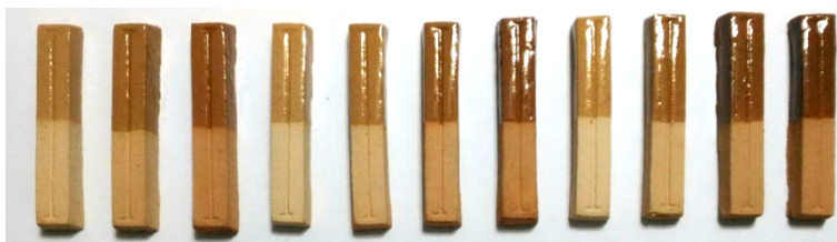
ภาพที่ 9 ผลิตภัณฑ์หล่อแม่พิมพ์ จากดินหล่อ ชุด B อัตราส่วนผสมลำดับที่ 11 หลังเผา
