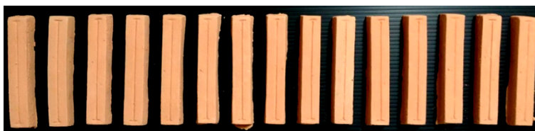
ภาพที่ 7 แท่งทดสอบน้ำดินหล่อแม่พิมพ์ ชุด B หลังเผาที่อุณหภูมิ 850 องศาเซลเซียส
