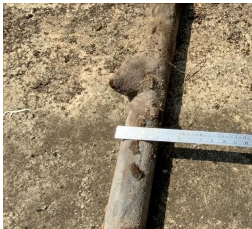
ภาพที่ 11 ปริมาณน้ำปูนที่ยึดเกาะเสาเข็มโครไฟล์เหล็ก
