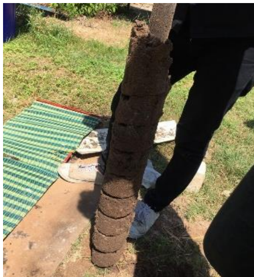
ภาพที่ 1 การเก็บตัวอย่างดินด้วยสว่านมือ
