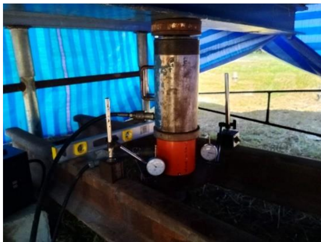
ภาพที่ 5 การทดสอบ static load test
