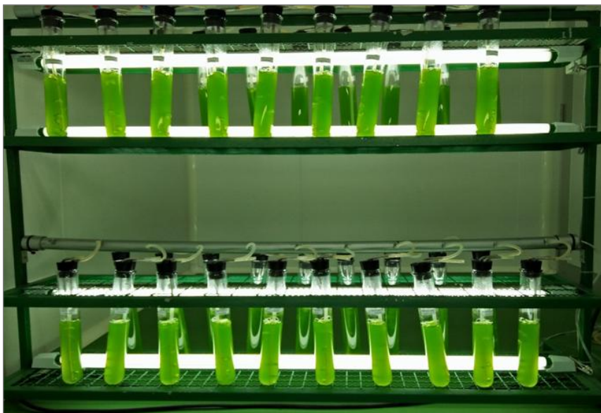
ภาพที่ 2 การเพาะเลี้ยงสาหร่ายสายพันธุ์ Chlorococcum sp. TISTR 8266 ในหลอดเพาะเลี้ยง ปริมาตรเพาะเลี้ยง 200 มิลลิลิตร วางบนแท่นเพาะเลี้ยงและให้แสงฟลูออเรสเซนต์ตลอดระยะเวลาเพาะเลี้ยง
