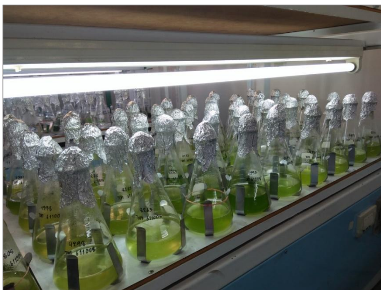
ภาพที่ 1 การเตรียมหัวเชื้อสาหร่ายสายพันธุ์ Chlorococcum sp. TISTR 8266 ในขวดรูปชมพู่ ปริมาตรเพาะเลี้ยง 200 มิลลิลิตร
