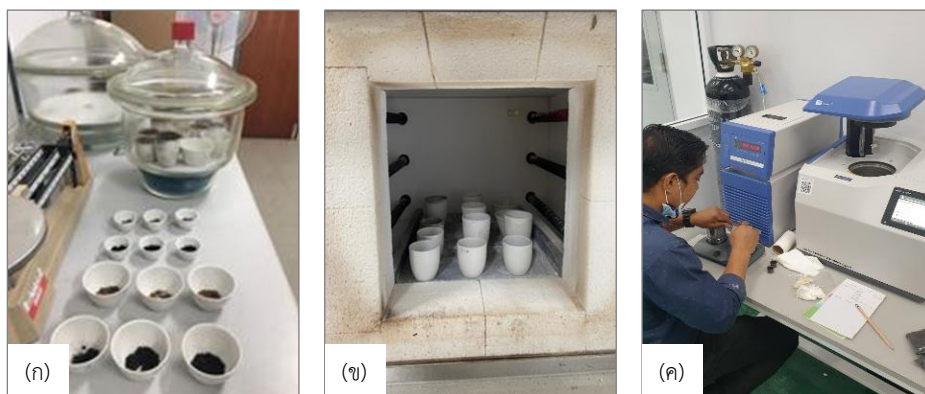
ภาพที่ 3 การเตรียมตัวอย่างวัตถุดิบเพื่อทดสอบสมบัติทางเคมี โดยการทดสอบหาปริมาณความชื้น (ก) นำตัวอย่างเข้าเตาเผาอุณหภูมิสูงเพื่อหาปริมาณเถ้า ปริมาณสารระเหย และปริมาณคาร์บอนคงตัว (ข) และหาค่าพลังงานความร้อนจากเครื่อง bomb calorimeter (ค)
