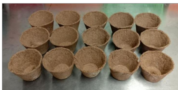
ภาพที่ 2 กระถางเพาะกล้าไม้จากวัสดุเหลือทิ้งการเพาะเห็ดแครงสำหรับใช้เป็นชิ้นงานทดสอบสมบัติต่าง ๆ
