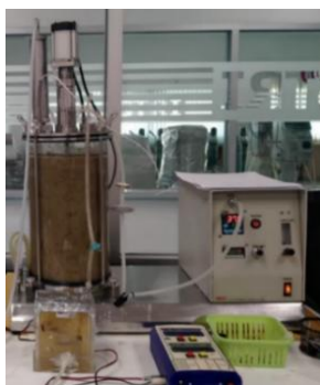
ภาพที่ 4 การผลิตก๊าซชีวภาพในถังปฏิกรณ์กวนสมบูรณ์ขนาด 10 ลิตร
