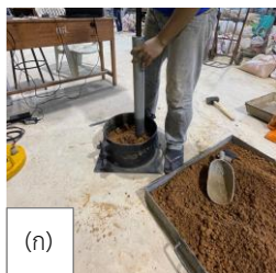
ภาพที่ 7 การทดสอบเพลทแบบพลศาสตร์ โดยการเตรียมตัวอย่างดิน (ก) การแต่งตัวอย่างดิน (ข) การทดสอบให้น้ำหนักกระทำต่อตัวอย่างดิน (ค) และการอ่านและบันทึกค่าผลการทดสอบเพื่อการวิเคราะห์เพิ่มเติม (ง)
