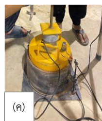
ภาพที่ 7 การทดสอบเพลทแบบพลศาสตร์ โดยการเตรียมตัวอย่างดิน (ก) การแต่งตัวอย่างดิน (ข) การทดสอบให้น้ำหนักกระทำต่อตัวอย่างดิน (ค) และการอ่านและบันทึกค่าผลการทดสอบเพื่อการวิเคราะห์เพิ่มเติม (ง)
