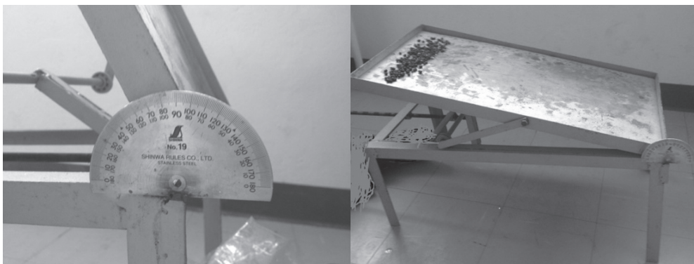
ภาพที่ 2 หามุมเสียดทานจลเพื่อออกแบบช่องป้อน
