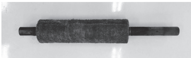
ภาพที่ 5 ลูกกลิ้งลอกเยื่อเมล็ดมะละกอ
