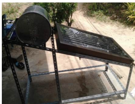
ภาพที่ 6 โครงสร้างฐานประกอบกับแผงรับพลังงานแสงอาทิตย์และถังเก็บน้ำร้อน
