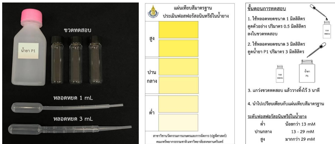
ภาพที่ 1 อุปกรณ์และแผ่นเทียบสีมาตรฐานชุดทดสอบฟอสฟอรัสอินทรีย์ในน้ำยาง
