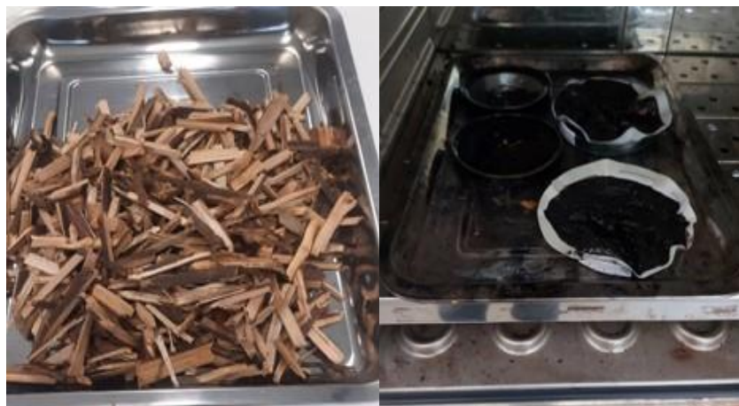
ภาพที่ 1 การเตรียมตัวดูดซับจากต้นไมยราบยักษ์ (ซ้าย) และถ่านกัมมันต์จากต้นไมยราบยักษ์ (ขวา)
