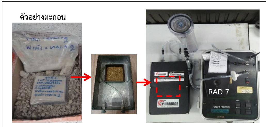
ภาพที่ 2 วิธีการตรวจวัดเรดอนแบบ Active detecting method
