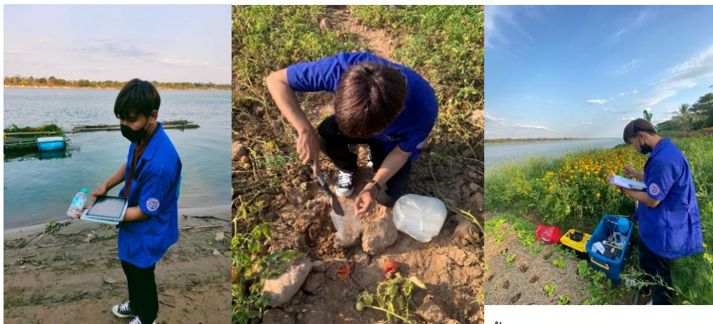
ภาพที่ 1 การสุ่มเก็บตัวอย่างตะกอนจากริมฝั่งแม่น้ำโขง
