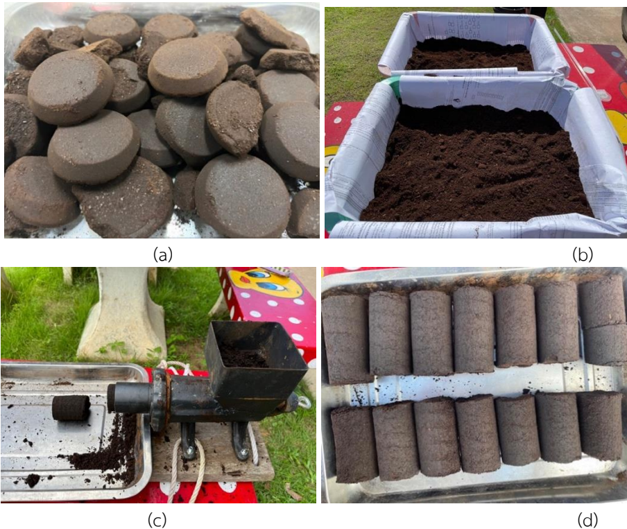
ภาพที่ 1 (a) กากกาแฟที่ได้จากร้านขายกาแฟ (b) การตากแห้งกากกาแฟ (c) การอัดแท่งกากกาแฟโดยใช้เครื่องอัดแท่งด้วยมือ (d) ถ่านอัดแท่งจากกากกาแฟ
