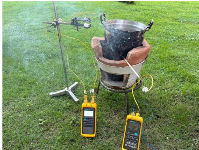
ภาพที่ 5 การจัดอุปกรณ์การหาประสิทธิภาพการใช้งานหุงต้มโดยทดสอบการต้มน้ำ
